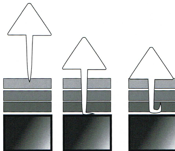
Figure 2 : La tige carrée du clou se retourne quand la pointe rencontre l'enclume du cordonnier. Extrait de Volken (2017)
